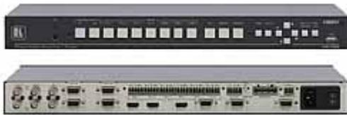
VP-730 は、アナログ映像、デジタル映像、バランス・ステレオ、S/PDIF 音声信号のための 9 入力スケーラー/スイッチャーです。コンポジット・ビデオ、s-ビデオ (Y/C)、コンポーネント・ビデオ (YUV)、HDMI、PC 映像、JPEG ファイルを、好みの PC 映像または HDTV 出力解像度にスケールアップまたはスケールダウンし、15 ピン HD コネクターから出力します。スピーカーを駆動するパワーアンプが内蔵されています。FTB™ (fade-thru-black) スイッチング技術により、スムーズなソース切替を可能にします。
