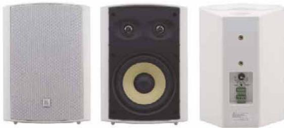
Yarden 6-0Dは、ケブラーコーンウーファー、チタンツイーター、2次クロスオーバーネットワーク採用の8Ω(トランススルー)又はアレー構成にしやすい70V/100Vライン用トランス内蔵の壁掛けスピーカーです
