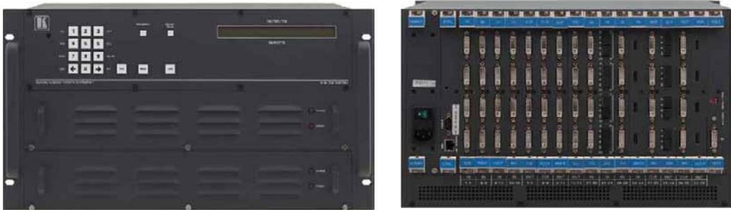
VS-3232DNは、DVIおよびHDMI信号用の高性能デジタルマトリックススイッチャー本体シャーシです。各種入出力モジュールを4入力および4出力単位で増設して、最大32x32のマトリックススイッチャーを構成することができます。本体には電源、コントロールモジュール、マトリックス内の各入出力をモニターしてテスト可能なテストモジュールが内蔵されています。
