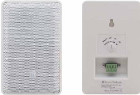
Yarden 4-0は、ケブラーコーン/2次クロスオーバーネットワーク採用の8Ω(トランスルー)、又はアレー構成にしやすい70V/100Vライン用のトランス内蔵の壁掛けスピーカーです
