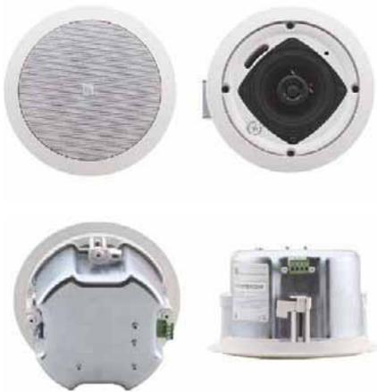
Galil 4-Cは、8Ω(トランススルー)、又はアレー構成にしやすい70V/100Vライン用のトランス内蔵の後面密閉型コンパクトシーリングスピーカーです
