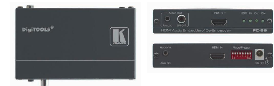
FC-69は、UHD(4K)対応のHDMI音声エンベッダー / ディエンベッダーです。アナログ音声をHDMI信号にエンベッドし、HDMI信号又は音声リターンチャンネルの音声をディエンベッドして、アナログ音声とS/PDIFに変換し同時出力します。
