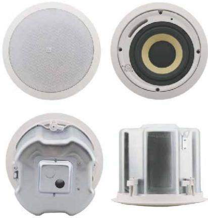
Yarden 6-CHは、天井の高い部屋や音響的に困難な空間でのスピーチの明瞭性、音楽の透明感の改善を意図した狭指向性シーリングスピーカーです。特定の周波数に焦点をあて、スピーカー直下に狭い視聴空間を創り出します。8Ω(トランススルー)、又はアレー構成にしやすい70V/100Vライン用のトランスを内蔵したマルチタップ方式を採用しています。
