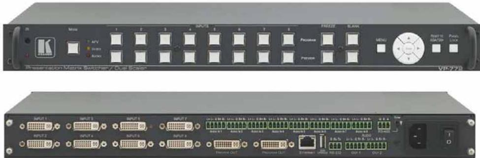
VP-772は、レンタル、ステージ、ライブイベント用の特殊エフェクト機能を持ち、デュアルスケーラーが必要な用途に最適な 4K対応8入力デュアルスケーラー DVI (HDCP) プレゼンテーションスイッチャーです。DVI-U入力 (アナログ、DVI、HDMI対応)とバランスオーディオ入力を採用致しました。選択したビデオ・オーディオ入力をスケーリング、プロセッシングして、2系統の独立したDVI-I 出力(プログラムとプレビュー)及び、2系統のバランスオーディオ出力に出力します。
