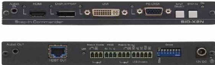
SID-X2Nは、PC映像、HDMI、DVI、DisplayPortとアンバランスステレオ音声用のスイッチャー&HDBaseTツイストペア送信器です
