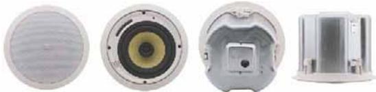
Yarden 6-Cは、ケブラーコーン/2次クロスオーバーネットワーク採用の8Ω(トランスルー)、又はアレー構成にしやすい70V/100Vライン用のトランス内蔵の後面密閉型シーリングスピーカーです
