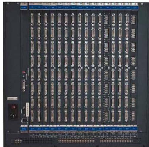
VS-6464DNは、DVIおよびHDMI信号用の高性能デジタルマトリックススイッチャー本体シャーシです。各種入出力モジュールを8入力および8出力単位で増設して、最大64x64のマトリックススイッチャーを構成することができます。
