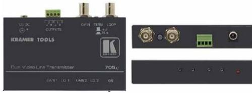
705XLは、伝送距離最大1000mのコンポジット映像 - 2系統出力ツイストペア送信器です
