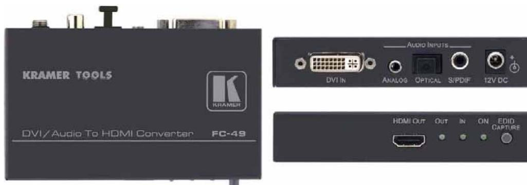
FC-49は、DVI-D映像及び音声信号（S/PDIF又はアナログステレオ）をHDMI信号に変換するコンバーターです
