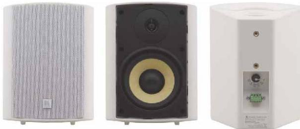
Yarden 5-0は、ケブラーコーン/2次クロスオーバーネットワーク採用の8Ω(トランスルー)、又はアレー構成にしやすい70V/100Vライン用のトランス内蔵の壁掛けスピーカーです
