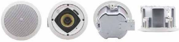
Yarden 4-Cは、ケブラーコーン/2次クロスオーバーネットワーク採用の8Ω(トランスルー)、又はアレー構成にしやすい70V/100Vライン用のトランス内蔵の後面密閉型シーリングスピーカーです
