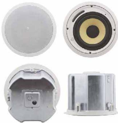
Yarden 8-CHは、天井の高い部屋や音響的に困難な空間でのスピーチの明瞭性、音楽の透明感の改善を意図した狭指向性シーリングスピーカーです。特定の周波数に焦点をあて、スピーカー直下に狭い視聴空間を創り出します。8Ω(トランススルー)、又はアレー構成にしやすい70V/100Vライン用のトランスを内蔵したマルチタップ方式を採用しています。
