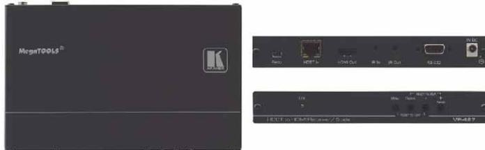
VP-427は、HDMI、双方向RS-232とIR信号用のHDBaseTツイストペアレシーバー / スケーラーです。HDBaseT信号を受信して、HDMI、IRとRS-232信号に変換し、映像をスケールアップ又はダウンします。
