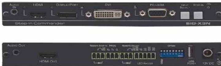
SID-X3Nは、PC映像、HDMI、DVI、DisplayPortとアンバランスステレオ音声用のスイッチャー&HDMI出力のステップインモジュールです
