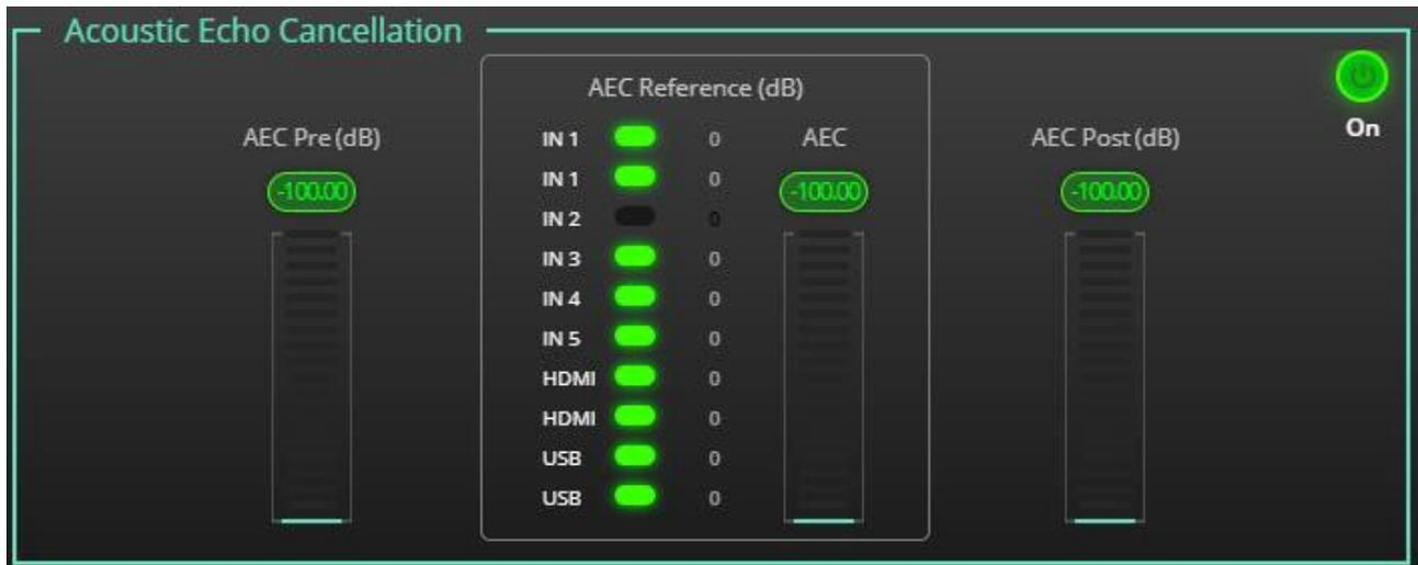
図34：プロセス ビュー - AEC モジュール
