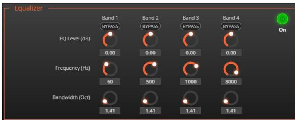
図32：プロセス ビュー - イコライザー モジュール
