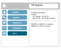
図56:ファームウェアのアップグレード - ロールバックするファイルのリスト
